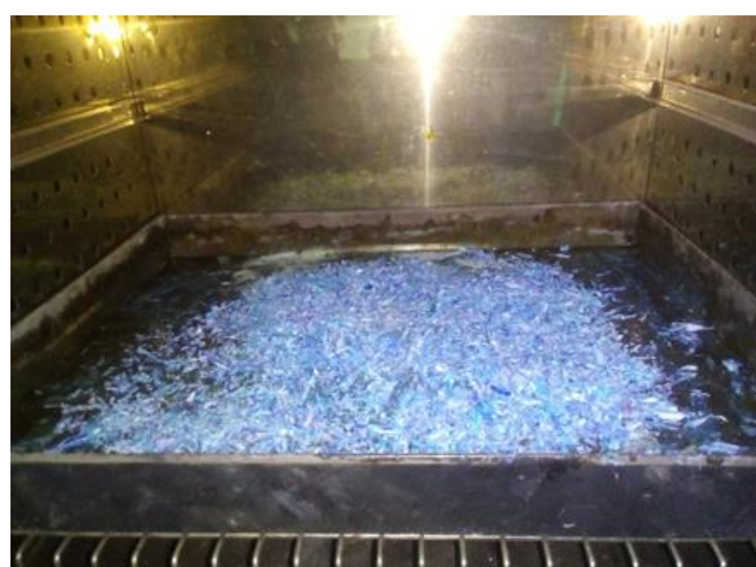
Proceso de ablandamiento de la mezcla plástica en el horno
